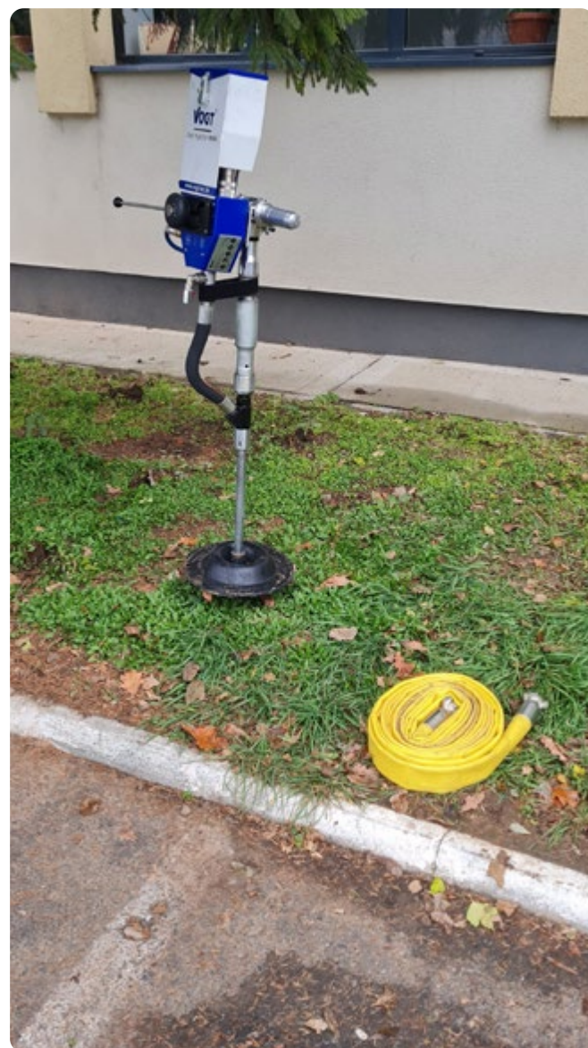
Fig. 5.4.2. Exemplu referitor la decompactarea solului prin injectarea cu aer comprimat; echipamentul din imagine inserează aer în sol cu mare viteză și produce astfel micro-fisuri care permit aerarea solului și, respectiv, pătrunderea apei în substrat pentru îmbunătățirea mediului de creștere
